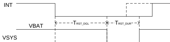
图 7 通过 INT 引脚的 VSYS 端口复位功能
