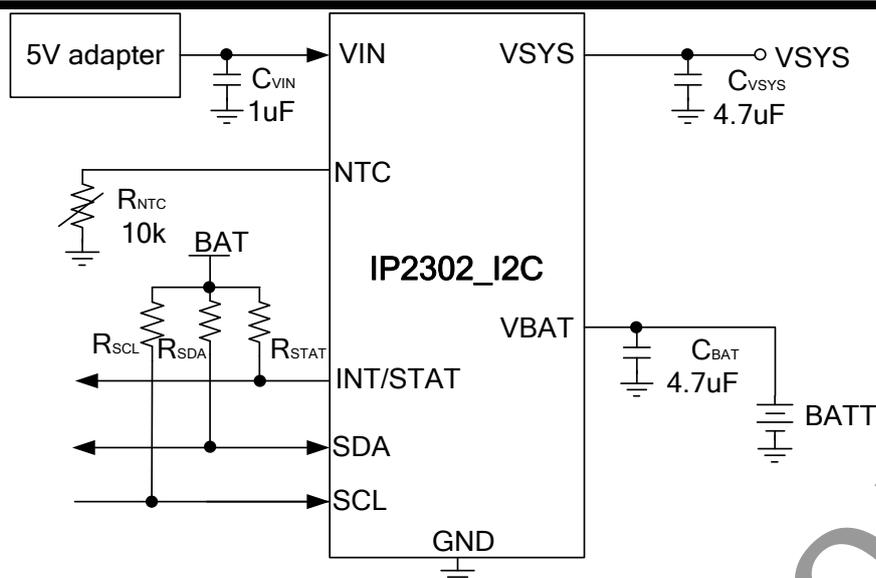
图 12 IP2302\_I2C 典型应用原理图
