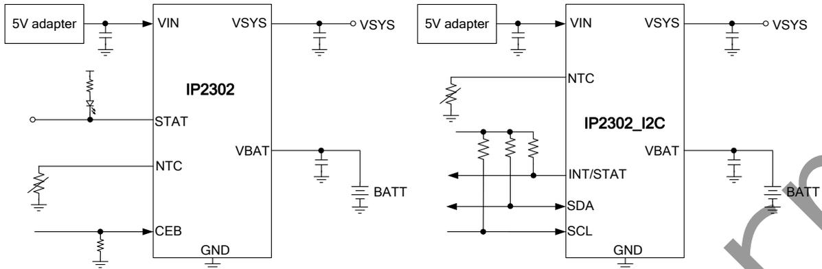
图 1 IP2302 和 IP2302\_I2C 简化应用原理图
